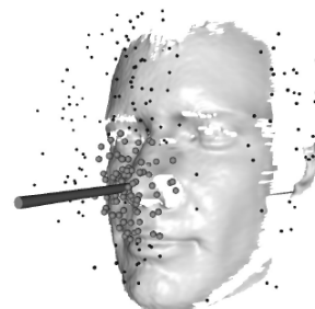
图 8 Mean-shift 对鼻尖点的聚类模型
